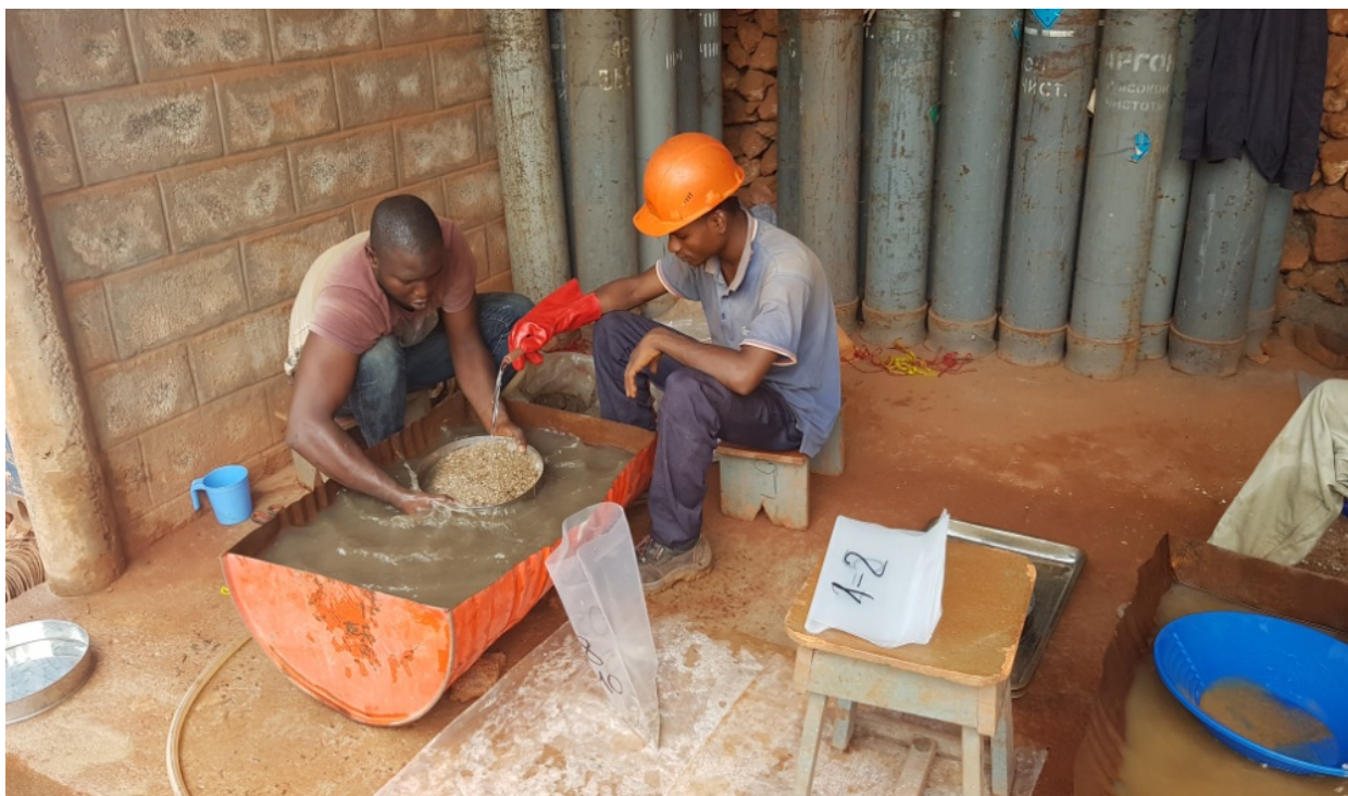
Fig. 13. Tamisage dans l'eau avec division en fractions: -10+5 mm, -5+2 mm, -2+1 mm et -1 mm
