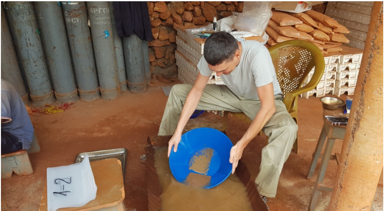
Fig. 14. Lavage sur une batée de la fraction -1 mm jusqu'à l'obtention du concentré gris
