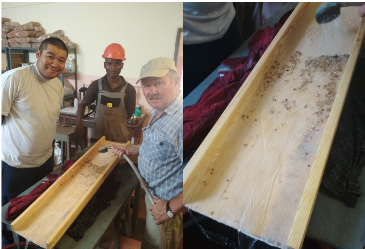
Fig. 16. Séparation pas graisses de la fraction -5+2 mm sur une table graissée
