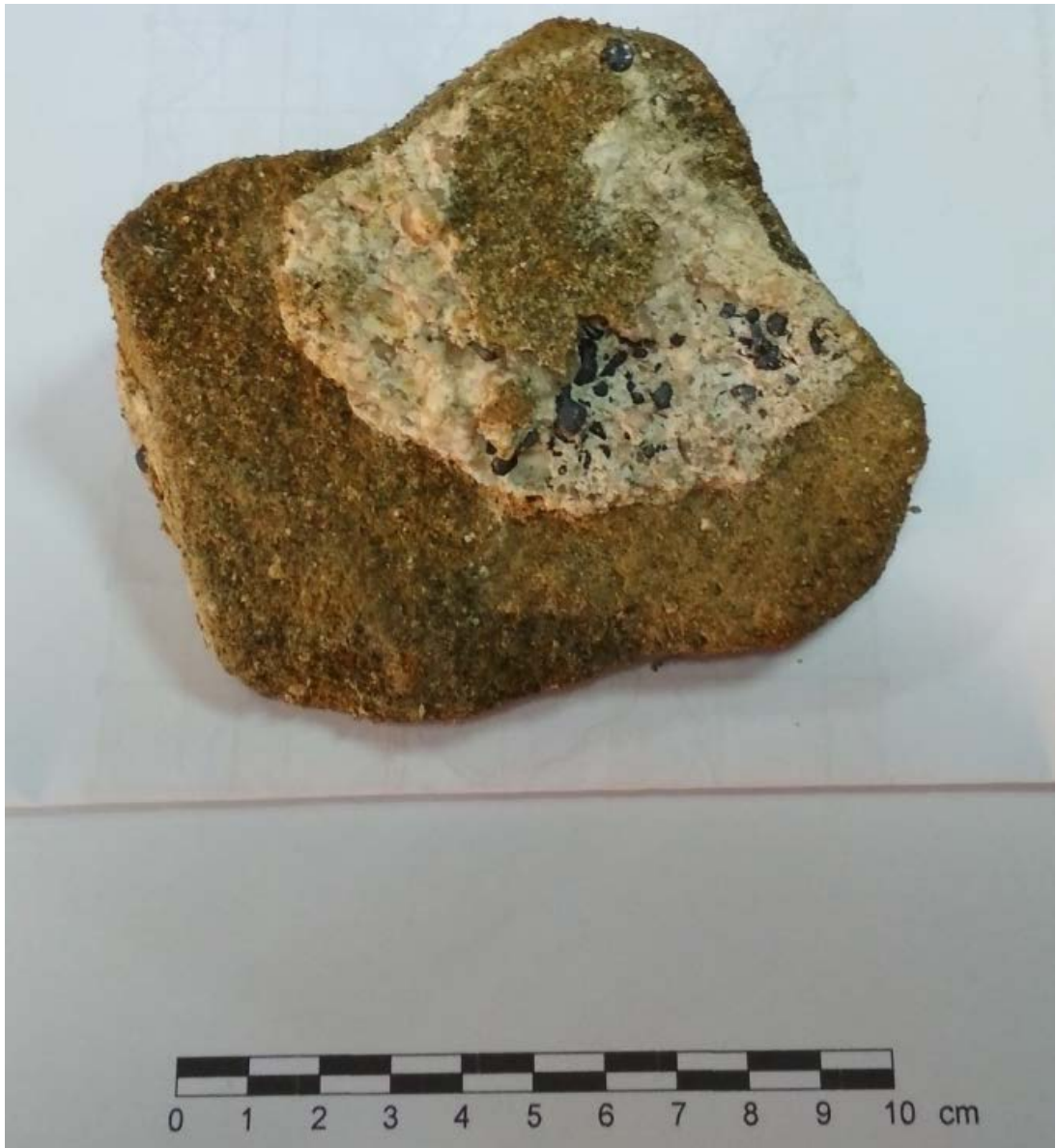
Fig. 10. Matériau cimenté sablo-graveleux (point 044)
